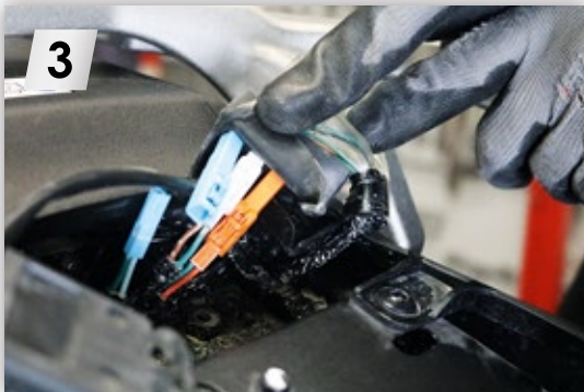
3 Stecker trennen. Disconnect the plug.
