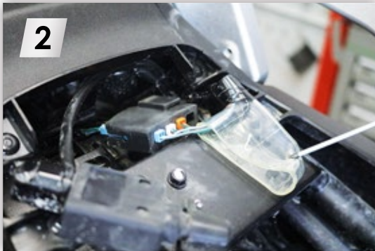
2 Steckerleiste vorsichtig rausziehen. Carefully pull out the connector strip.
